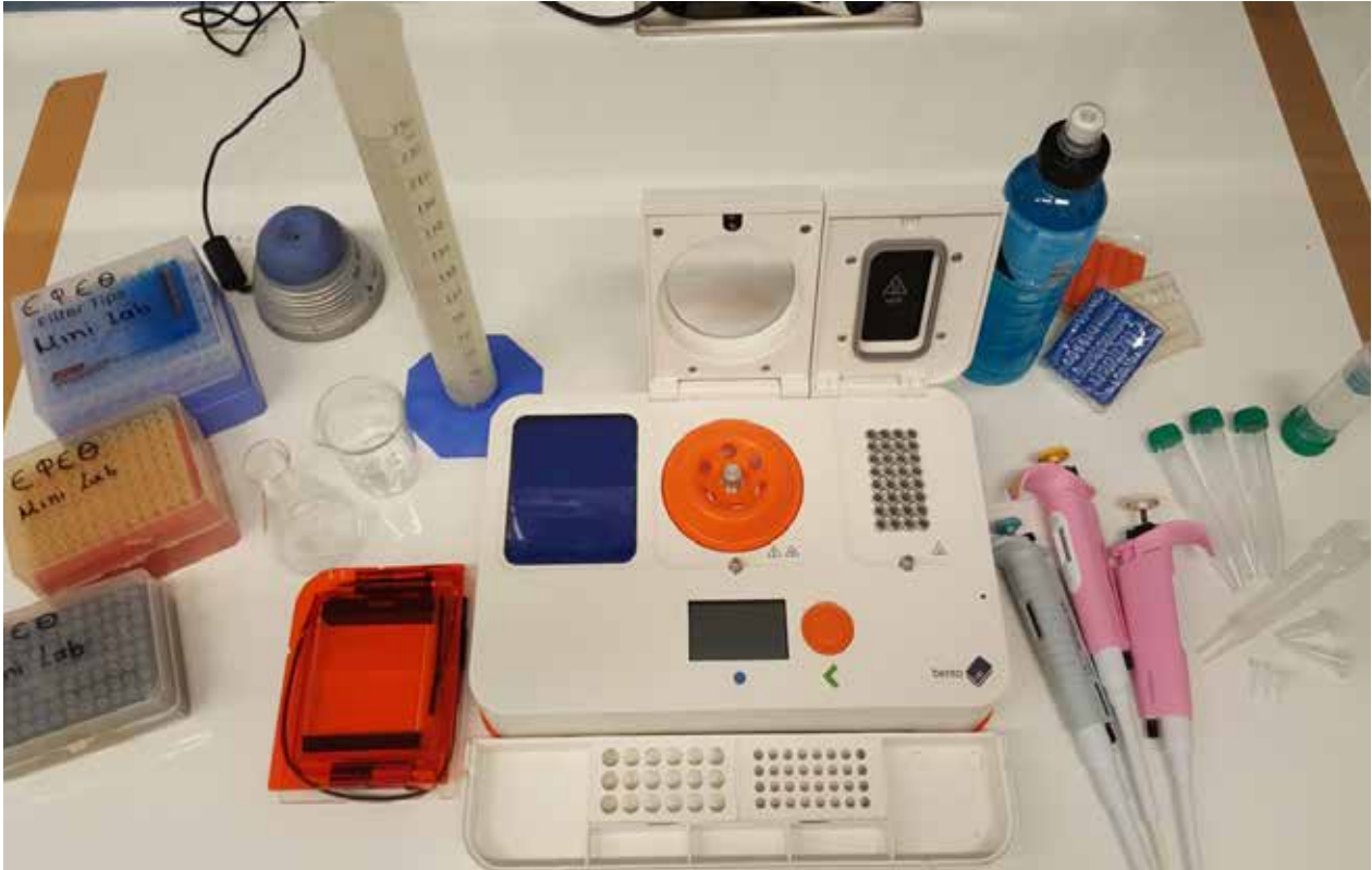
Εικόνα 1: Το φορητό εργαστήριο μοριακής βιολογίας 2MoBiL. Η συσκευή περιλαμβάνει θερμικό κυκλοποιητή, φυγόκεντρο, συσκευή ηλεκτροφόρησης, καθώς και τράπεζα οπτικοποίησης του τελικού αποτελέσματος. Τη συσκευή συνοδεύουν ρυθμιζόμενες πιπέττες ακριβή όγκου, πλαστικός ογκομετρικός σωλήνας, κωνική φιάλη, ποτήρι ζέσεως, στροβιλοαναδευτήρας, εστία θέρμανσης και τράπεζα διερχόμενης υπεριώδους ακτινοβολίας, πλαστικά ακρορύγχια μιας χρήσης, αυτοπωματιζόμενα σωληνάρια πολυπροπυλενίου, βιδωτού πωματισμού ακρυλικού δοκιμαστικού σωλήνες και όλα τα απαραίτητα αναλώσιμα για τη διεξαγωγή των πειραμάτων των πέντε εργαστηριακών φάσεων. Το φορητό εργαστήριο είναι κατάλληλα σχεδιασμένο για εύκολη και γρήγορη μεταφορά.
